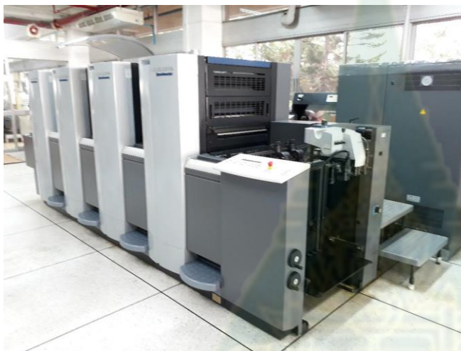
ส่วนพิมพ์แบบแนวนอน 4 หน่วยพิมพ์และส่วนป้อน
