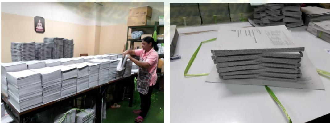
ภาพที่ 3.13 งานเก็บเล่มแบบซ้อนของเอกสารการสอน
