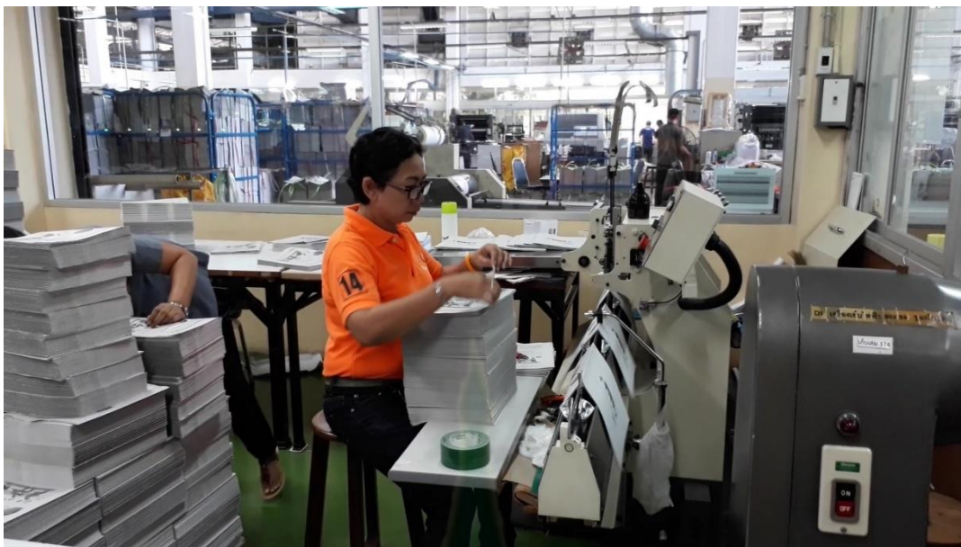
ภาพที่ 3.17 เครื่องทำเล่มแบบเย็บมุงหลังคาด้วยลวด รุ่น Saddle Stitcher Model S-450
