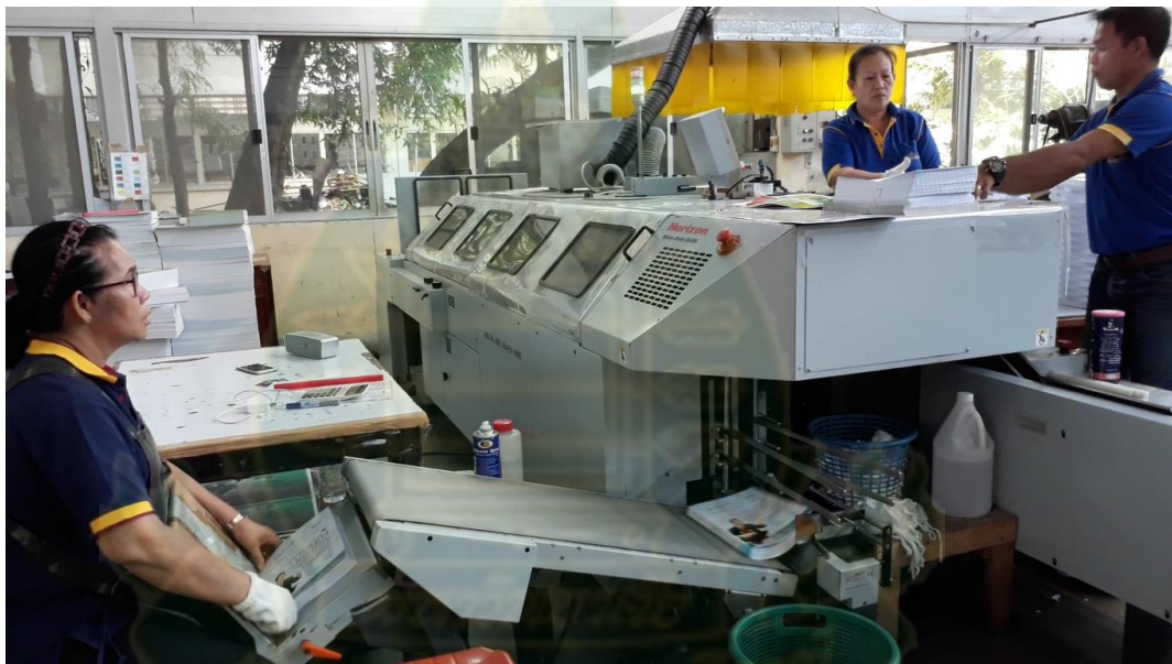
การไสสันทากาวจนได้ตัวเลขหนังสือออกมาที่ส่วนรับ
