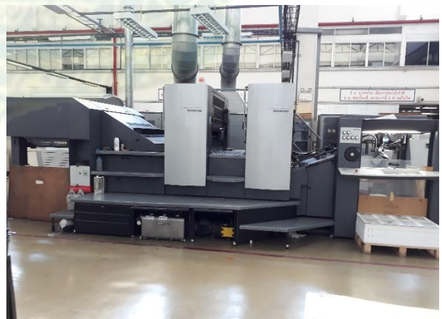
ส่วนรับ ส่วนพิมพ์แบบแนวนอน 2 หน่วยพิมพ์ ส่วนป้อน
