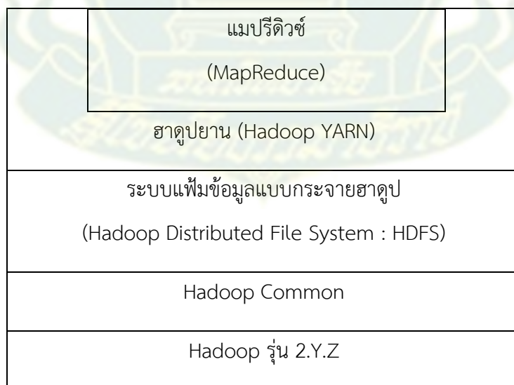
ภาพที่ 3.7 โครงสร้างหลักการทำงานของฮาดูปรุ่น 2.Y.Z (วฤชาย์ ร่มสายหยุด, 2560)
